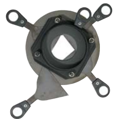
4 Lamelle sagomatrici estraibili, montate su piastre con superficie di scorrimento trattata anti abrasione e molle a corsa lunga per garantire nel tempo la perfetta manovrabilità delle lamelle.
