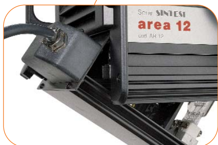
Interruzione automatica bipolare dell'alimentazione all'apertura dello sportello lampada attraverso microswitch
